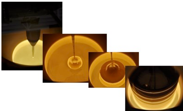
Figura 2. Proceso de crecimiento de un lingote monocristalino. Cortesía de CENTESIL
