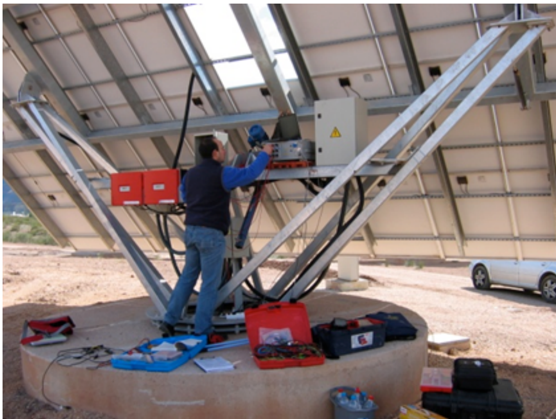
Figura 4. Medidas de funcionamiento de un conjunto de paneles con seguidor solar. Cortesía del Instituto de Energía Solar.
