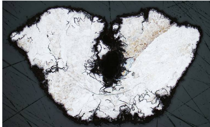
Sección de una rejilla con pobre resistencia a la corrosión
