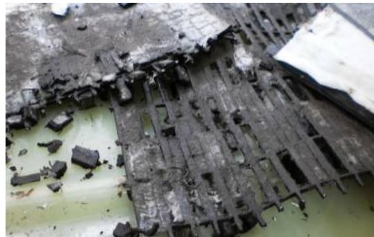
Ejemplo de pobre adherencia de la pasta, causando muerte acelerada en una batería
