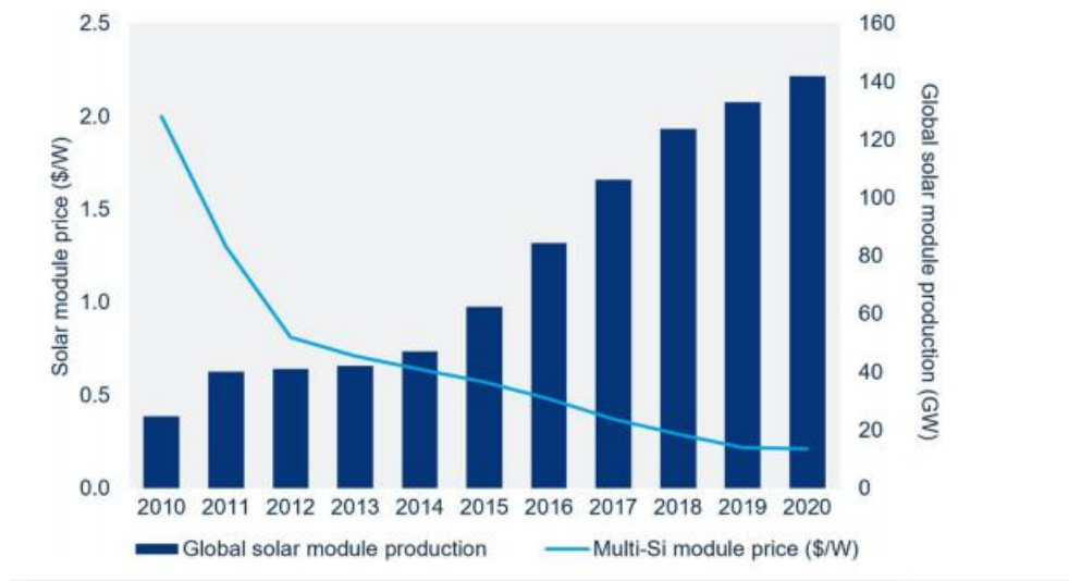
Figura 28. Evolución de los precios de los módulos fotovoltaicos 2010-2020 ($/W) y producción mundial de módulos (GW). Fuente: IEEFA.
